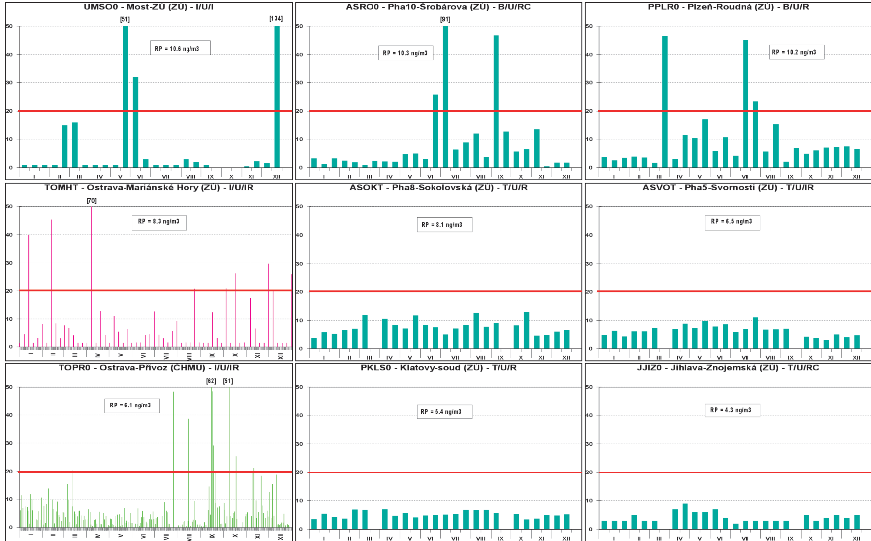
Obr. II.4.2.40 1/14denní průměrné koncentrace niklu v ovzduší na vybraných stanicích v roce 2007 Fig. II.4.2.40 1/14-day average concentrations of nickel in the ambient air at selected stations in 2007
