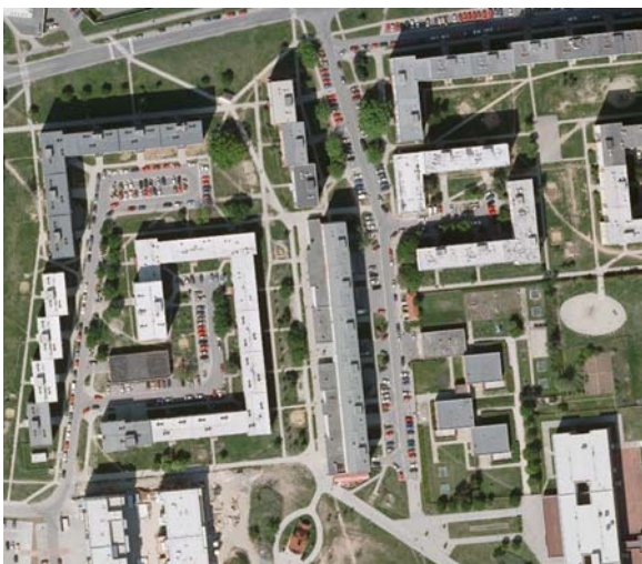
Obr. 100 Družební (Nové sady) struktura: volný sídlištní typ zastavěnost: 22%; výška: 24,5 m; hustota 260 obyv. /ha
