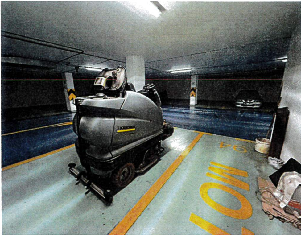
Řešení odstranění odkapané vody z aut mobilním podlahovým mycím strojem s odsáváním
